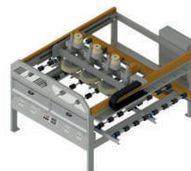
A **Enceratriz AGF** é um equipamento de fácil operação e indispensável no acabamento final de alguns materiais. Conta com três circuitos independentes de cera, possibilitando o uso de produtos químicos e acabamentos variados sem comprometer a integridade dos componentes. A rotação das escovas é controlada por inversores de frequência individuais, que permite reduzir ou aumentar o giro dos motores de modo individual.
