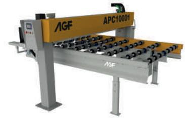
A **Aplicadora de Cola AGF** é o que há de mais prático e econômico para proteger as chapas de riscos causados pelo atrito entre as chapas no estoque. Uma fina camada de cola é aplicada sobre a face polida de cada chapa, criando um espaçamento mínimo entre duas chapas, impedindo assim o contato direto entre ambas.
